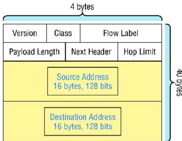
**FIGURE 14.7** IPv6 header
