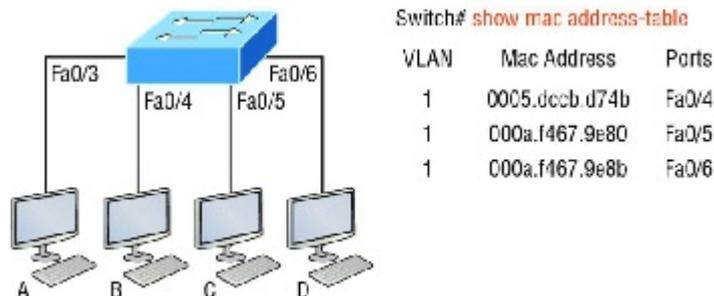
**FIGURE 10.3** Forward/filter table
