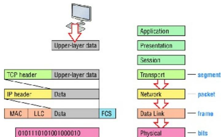
**FIGURE 2.21** Data encapsulation
